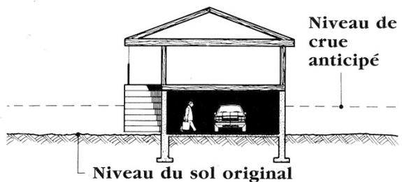
Au moment de la construction, on peut élever les bâtiments sur des pieux et des colonnes à titre de méthode de protection. L'aire ouverte sous le bâtiment peut servir à d'autres fins, comme un stationnement, en dehors des périodes de crue.
